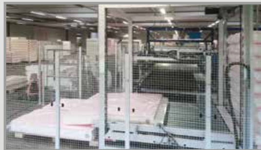
PACKED MATTRESS CORES SIDE UNLOADING (RIGHT AND LEFT SIDE) SCARICO LATERALE DEI MATERASSI IMBALLATI (LATO DESTRO E SINISTRO)
