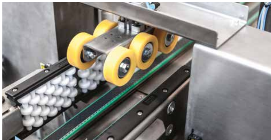
RETAINING SKATING DEVICE PATTINO DI RITEGNO DEL LONGHERONE
