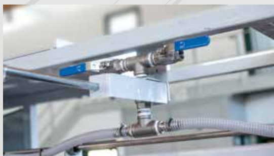
AUTOMATIC FEEDING SYSTEM CAN ACCOMODATE 2 GLUE RESERVOIRS ALIMENTAZIONE CON PREDISPOSIZIONE PER 2 TANICHE
