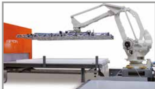
HYBRID NEEDLE AND SUCTION CUPS GRIPPER SISTEMA DI PRESA IBRIDO AD AGHI E VENTOSE
