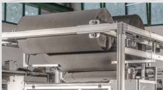
DOUBLE REELS FEEDING SYSTEM ALIMENTAZIONE A DOPPIA BOBINA
