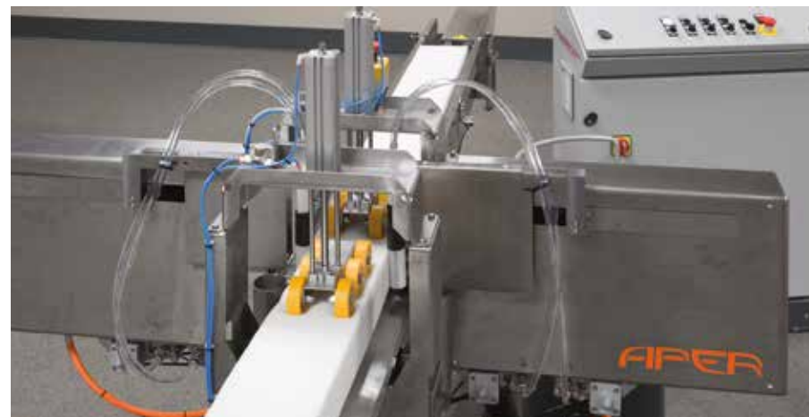
THE FOAM RAIL IS HELD FIRMLY IN PLACE DURING THE ADHESIVE APPLICATION PROCESS SISTEMA DI STABILIZZAZIONE DEL LONGHERONE DURANTE L'APPLICAZIONE DELLA COLLA
