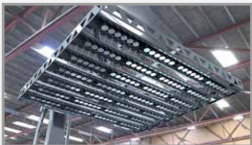
HYBRID NEEDLE AND MAGNETS GRIPPER SISTEMA DI PRESA IBRIDO AD AGHI E MAGNETI
