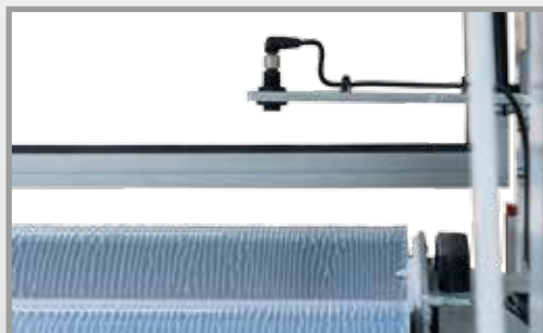
AC2 - GLUE LEVEL PHOTOSENSOR AC2 - FOTOCELLULA RILEVAMENTO LIVELLO COLLA
