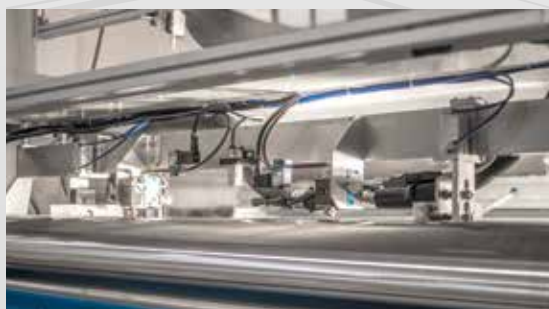
AUTOMATIC FEEDING SYSTEM FOR ADHESIVE AND ADJUSTABLE POSITIONING OF THE GLUE SEALING PADS (DETAIL) PARTICOLARE DELL'ALIMENTAZIONE COLLA E SISTEMA DI TENUTA REGOLABILE
