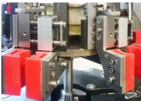
Pinza di applicazione e stiratura sigillo a U su tappo U seal on-cap application and smoothing gripper
