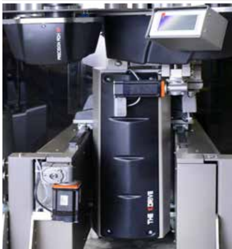
Stazioni etichettaggio robotizzate, assi di regolazione automatici Robotized labelling stations, automatic adjustment axes
