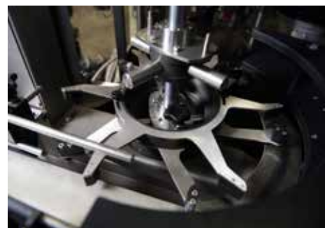
Stella variabile universale, regolazione 60/120 mm, per contenitori cilindrici Universal variable star, adjustment 60/120 mm, for cylindrical containers
