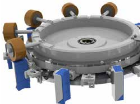
Pinza di applicazione e stiratura sigillo a I / L su tappo I/L seal on-cap application and smoothing gripper
