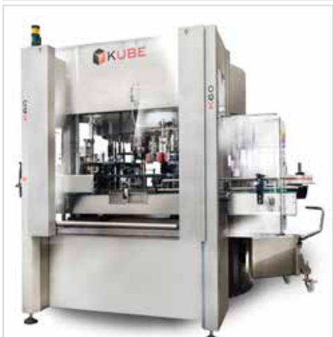
Apertura porte fronte macchina in verticale con contrappesi Vertical counterweighted opening of frontal machine door
