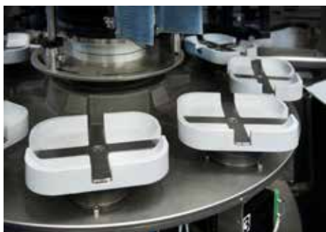
Piattello autocentrante di profondità con espulsore meccanico Self-aligning depth plate with mechanical ejector
