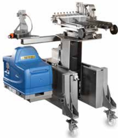
Stazione etichettaggio colla caldo KUBE HM KUBE HM hot glue labelling station
